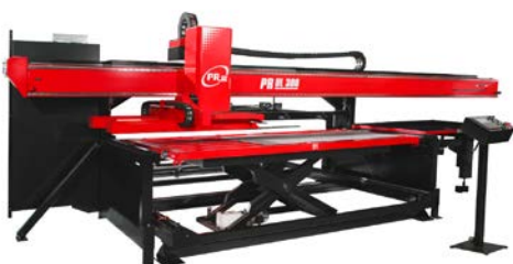
Für die Entnahme und Einzelsortierung: der Part Remover PR III 300 UL A.
