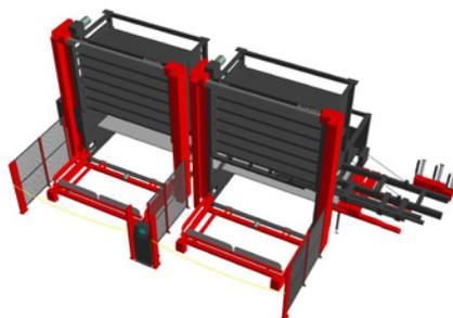
Be- und Entladetürme mit integrierter Teilesortierung.
